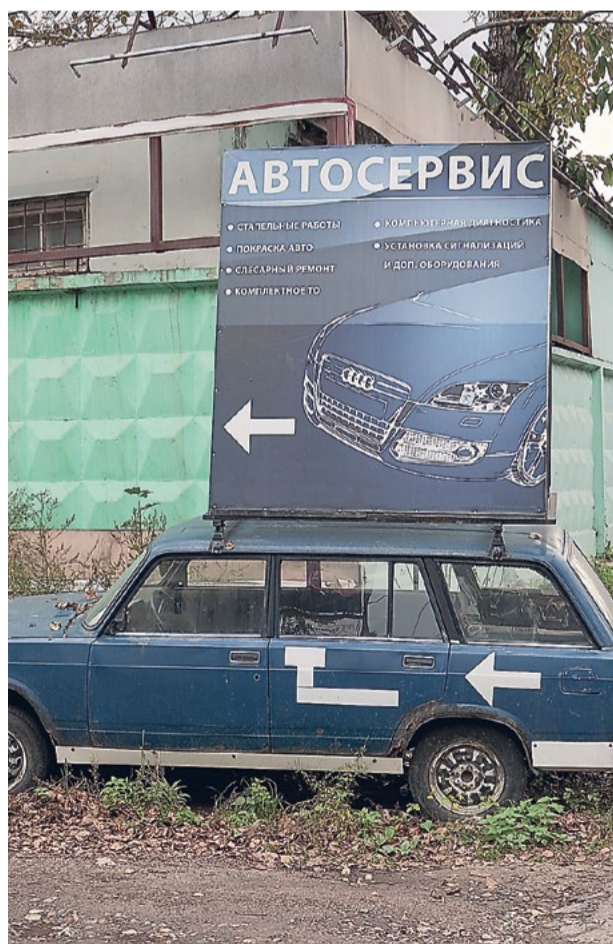
Установка на крыше автомобиля самодельных конструкций, не соответствующих требованиям безопасности, является внесением изменений в конструкцию транспортного средства и влечёт за собой административную ответственность
