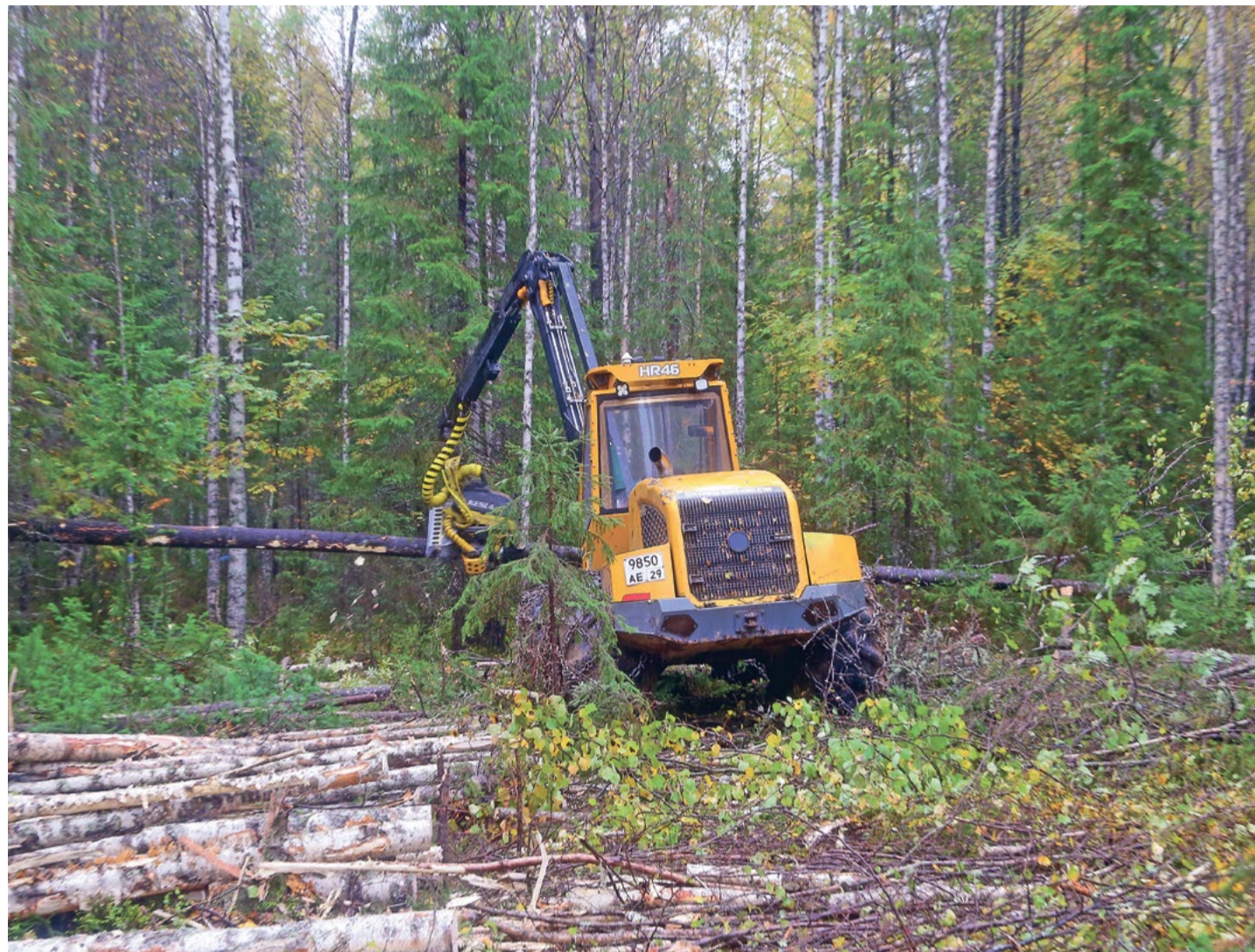
На коммерческих рубках ухода в делянках, где полвека назад шла промышленная заготовка древесины, свою эффективность доказал легкий маневренный харвестер «Сампо»
